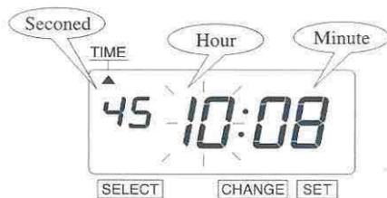
**1** – Pressez le bouton **FONCTION** pour positionner la marque « ^ » de la partie supérieure de l'afficheur sur le thème « TIME »
