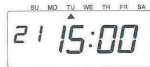
**2** – Presser le bouton **ENTER** une nouvelle fois et l'appareil revient en mode normal
